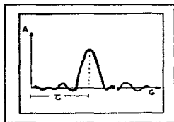
Figura 3.8 Autocorrelación para determinar la amplitud más grande de correlación que se asocia al desplazamiento \tau mínimo necesario para alinear el evento de reflexión.
