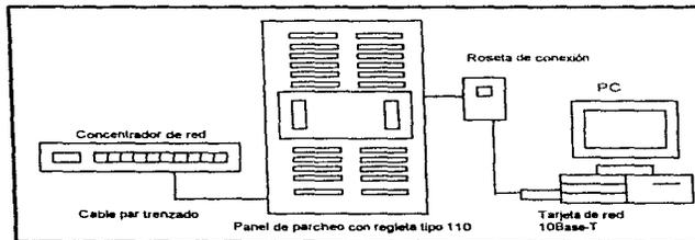
**Figura IV.1.8. Cableado UTP en Teimex.**
