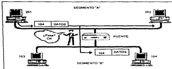
Figura II.3.14. Operación de un puente.
