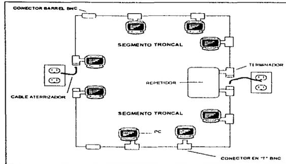
Figura II.2.9. Red Ethernet con cable coaxial delgado.
