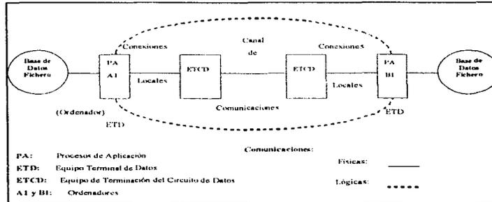
Figura I.3.1. Esquema general del sistema de comunicación de datos.
