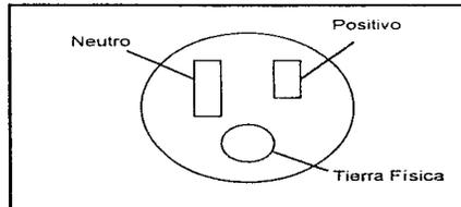
Figura IV.1.12. Polarización para los contactos eléctricos.
