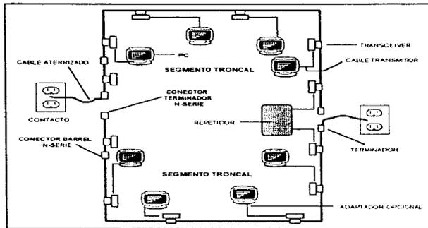
Figura II.2.10. Red ethernet con cable grueso.
