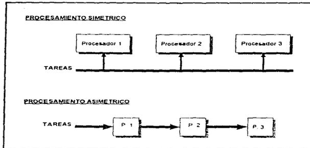
Figura III.2.1. Procesamiento simétrico y procesamiento asimétrico.
