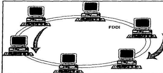
Figura II.2.3. Configuración para la topología de anillo doble redundante.
