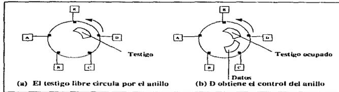
Figura II.2.8. Red con paso de testigo en anillo.
