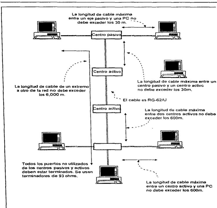
Figura II.2.11. Reglas de configuración para una red ARCnet.
