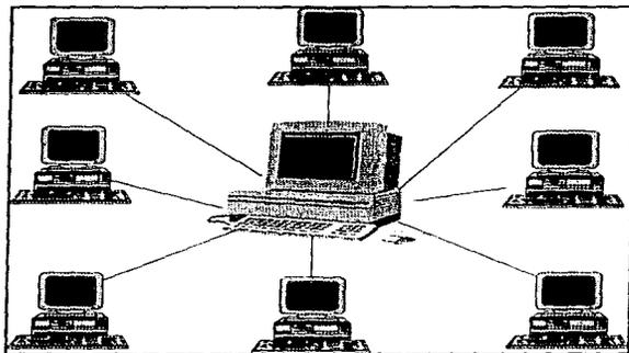
Figura II.2.1. Configuración de la topología en estrella.
