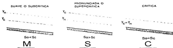
FIGURA 25. Diferentes tipos de perfiles con pendiente positiva.
