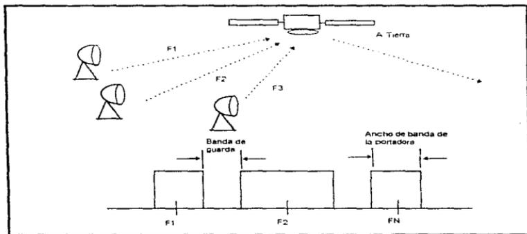
Figura 2.12. Concepto de un Sistema FDMA.
