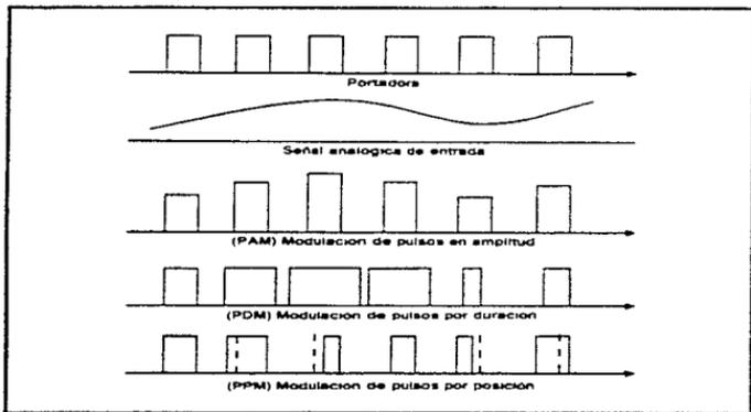
Figura 1.11. Sistemas de modulación por pulsos.
