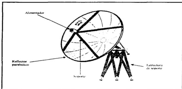
Figura 3.15. Antena de estación remota con alimentador frontal.
