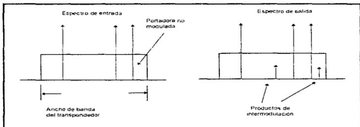
Figura 2.13. Productos de intermodulación en un transpondedor del satélite.
