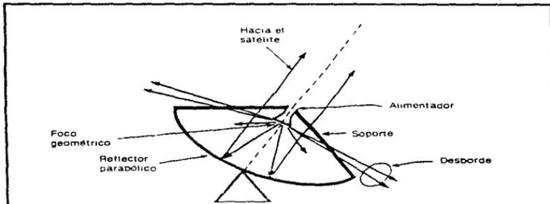
Figura 1.20. Antena parabólica con alimentación frontal (modo transmisión).
