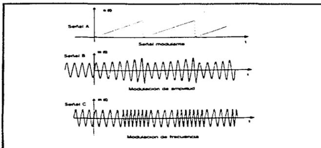
Figura 1.5. Modulación de amplitud y modulación de frecuencia señal modulada de origen analógico.
