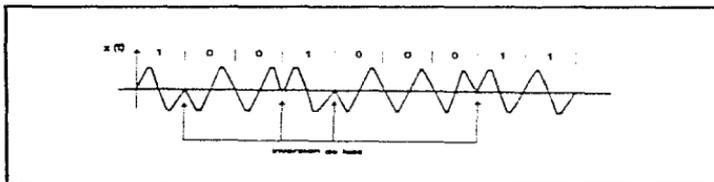
Figura 1.8. Señal BPSK en función del tiempo.
