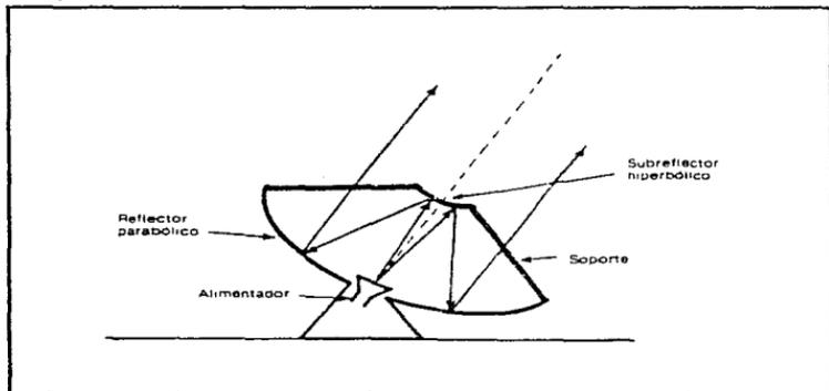
Figura 1.22. Antena Cassegrain con alimentador frontal (modo transmisión).
