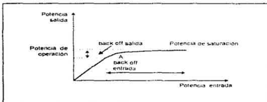
Figura 2.14. Operación de un amplificador de satélite
