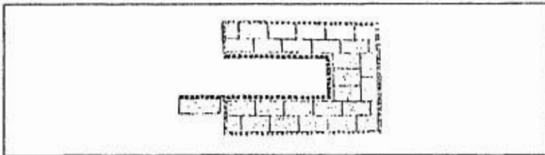
Figura III.9 Horno de Mufla. Una caja con una resistencia en devanados en el interior. Muchos hornos no tienen enrollados en la puerta o en la superficie opuesta a la misma. Tomadas del libro "Técnicas de Metalurgia Experimental" de Seybalt y otros.
