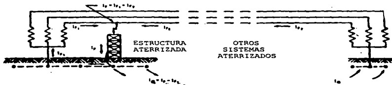
Figura 8 Falla local en la subestación, sistema aterrizado localmente y en otros puntos.
