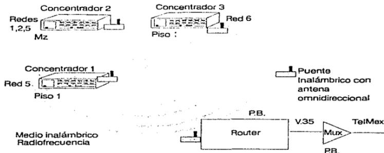
Esta alternativa involucra usar medios inalámbricos para unir los concentradores a través de radiofrecuencia. En este caso un dispositivo emisor se encarga de montar los datos en una frecuencia de radio determinada, agregarles un código de seguridad y distribuirlos. Del otro lado, son recibidos por el receptor, ajustado a la misma frecuencia y mismo código de seguridad.
