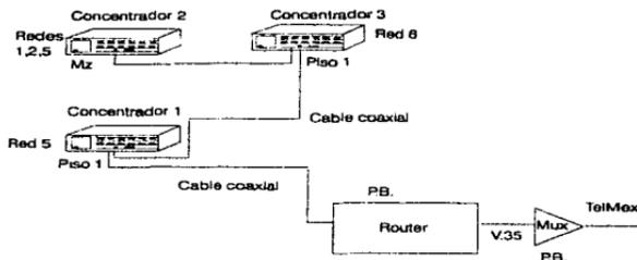
Para implementar el cableado principal o backbone se propone utilizar cable coaxial delgado (RG-58) para unir los concentradores. El recubrimiento que presenta este cable lo protege del medio ambiente, de interferencias eléctricas lo cual resulta muy adecuado si se tiene en mente que el cableado tendrá que pasar por sitios expuestos a factores ambientales.
