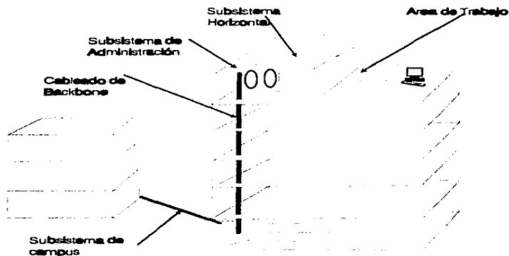
Los componentes de un cableado estructurado son los siguientes:
