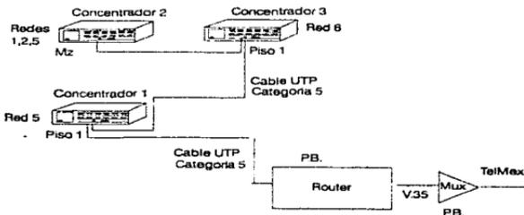
Esta propuesta propone utilizar cable UTP para implementar el backbone y de esta manera unir los concentradores. Se utilizará cable de 20 a 24 AWG sin malla. Los conectores que se usarán son RJ-45. La distancia entre concentradores no debe exceder los 100 metros. Los bajos costos de este cable y la ventaja de aprovechar los cableados telefónicos existentes hacen que este tipo de cableado se este volviendo muy popular para las instalaciones de redes.
