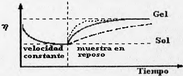
Figura A.1 Diferentes curvas que representan el comportamiento de un material tixotrópico.
