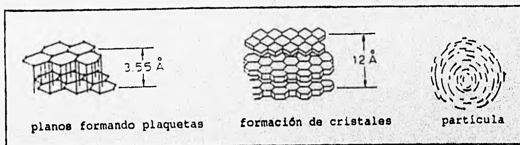
Fig. II.4 Esquema de la Microestructura de una Partícula de Hollín.
