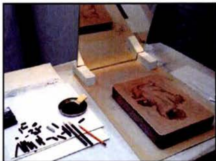
En la litografía el dibujo se hace directamente sobre la piedra.
