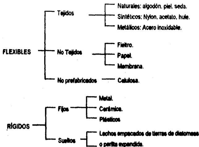
La mayoría de los medios filtrantes pueden obtenerse con tamaño de poro específico para satisfacer las aplicaciones de filtración particulares de que se trate.
