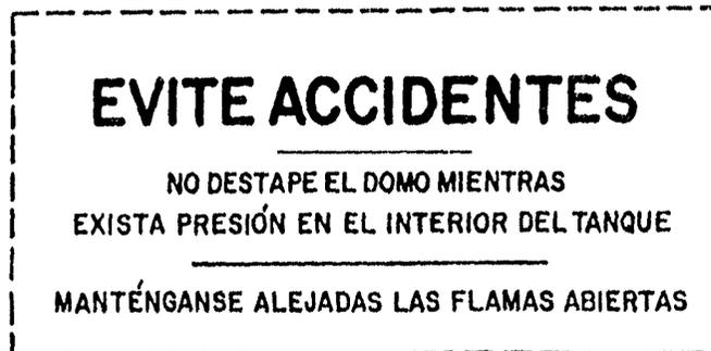
Los carros tanque de las especificaciones ICC-104, ICC-104-W o ARA-IV A que transporten OE, deben tener sus registros cerrados herméticamente y equipados con guardas de seguridad, de tal manera que mientras exista presión en el interior del tanque, sea prácticamente imposible la apertura de los registros. Estos carros tanque deben llevar marcas a los lados de los domos y alineadas con las escaleras de acceso (de un color que contraste):
