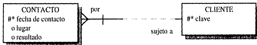
FIG. II.39 Creación de una Entidad Adicional (Contacto)
