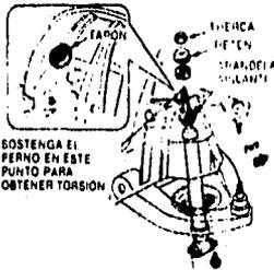
Soporte de montaje del amortiguador delantero (© Div. Chevrolet de G.M. Corp.).
