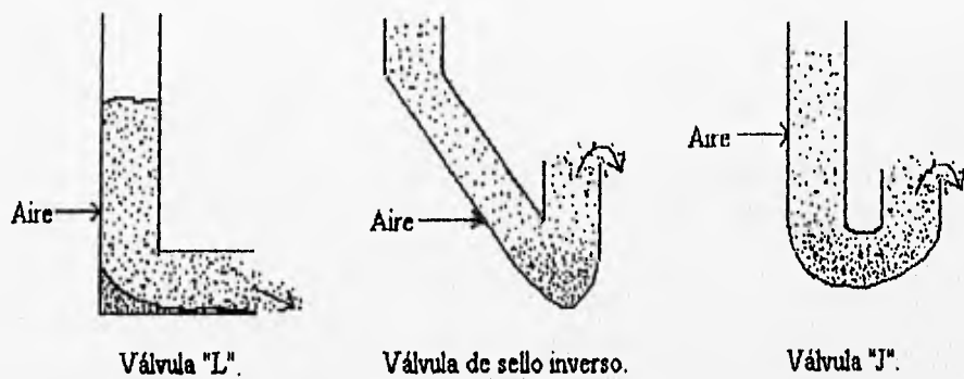
Figura B.1. Válvulas no mecánicas.
