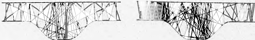
fig. 5.22. Sismogramas sintéticos en estaciones en la superficie del modelo de la fig. 5.19. Incidencia de ondas SH con \gamma = 60^\circ . Las figuras inferiores muestra el trazado de rayos para una incidencia de 0 y 15 grados en la superficie irregular.
