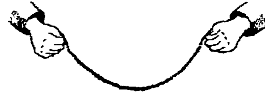
14. Catenaria, elemento flexible que sujeto de sus extremos se genera por acción de la gravedad.
