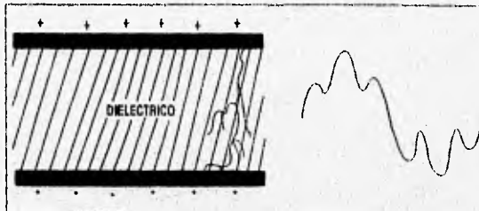
FIGURA 1.6.1 DESCARGA PARCIAL O CORONA EN EL CAPACITOR DIELECTRICO RESULTADO DEL VOLTAJE DE DISTORSION PROVOCADO POR ARMONICAS
