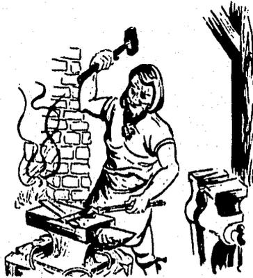
Fig. 1.1 Un herrero haciendo soldadura por forja
