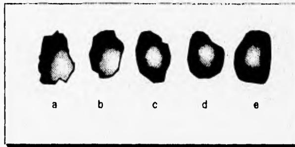
**Fig. III.1.** Escala visual para el grado de redondez de los granos del sedimento a) angular b) subangular c) subredondo d) redondo e) bien redondo
