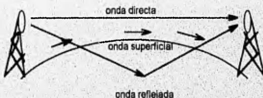
**FIGURA 1.4.6 COMPONENTES DE LA ONDA DE TIERRA**
