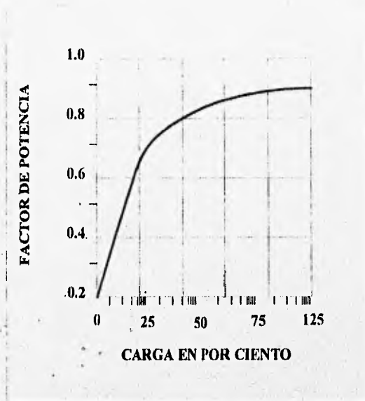
FIGURA 14 VARIACIÓN DEL FACTOR DE POTENCIA CON LA CARGA DE UN MOTOR DE INDUCCIÓN
