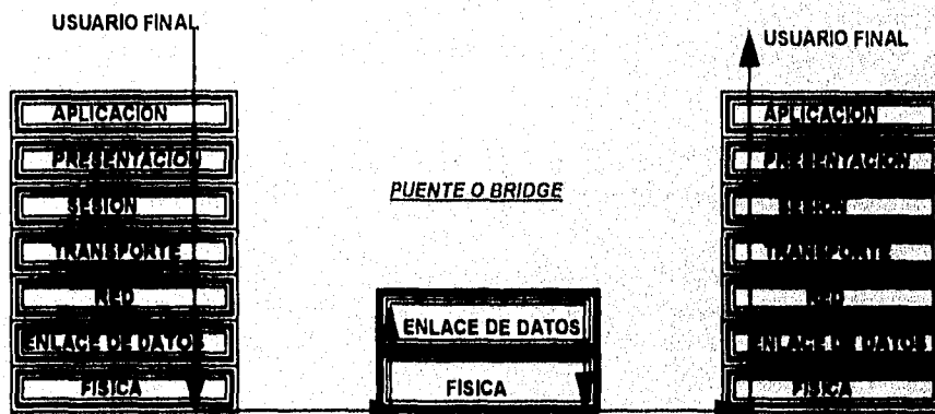
Figura 3.2 Modelo de un puente de acuerdo al modelo OSI.
