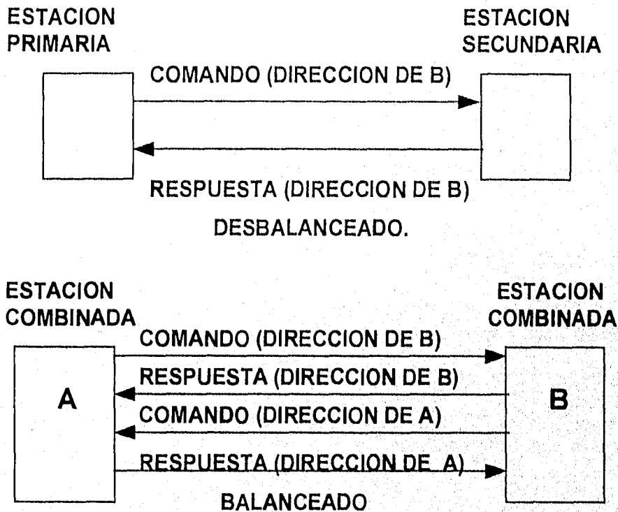
Figura 2.13 Diferentes tipos de estaciones y reglas de direccionamiento HDLC.
