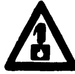
Peligro de quemaduras
