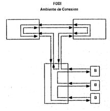
FDDI es un protocolo de red para transmitir datos a una velocidad de 100 millones de bits por segundo.
