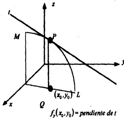
FIGURA 1.11B INTERPRETACIÓN GEOMÉTRICA DE LA DERIVADA PARCIAL DE LA FUNCIÓN  $z=f(x,y)$  CON RESPECTO A  $y$ .
