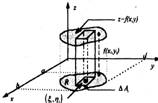
FIGURA 1.26 APROXIMACIÓN DEL VOLUMEN DE UN SÓLIDO CON PRISMAS RECTANGULARES
