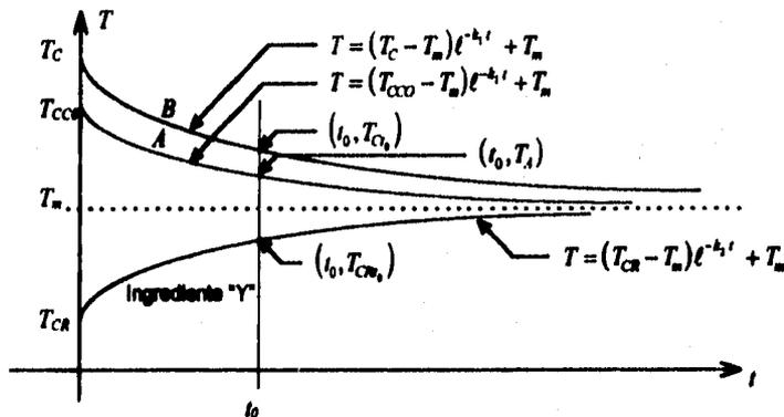
FIGURA 1.34 TEMPERATURA DE LA SOLUCIÓN "X" EN EL TANQUE A, B Y DEL INGREDIENTE "Y".
