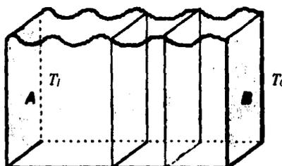
FIGURA 1.30 FLUJO DE CALOR A TRAVÉS DE UNA PLACA DE MATERIAL SÓLIDO
