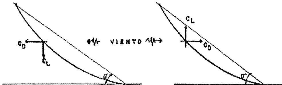
FIG. 4.8 COEFICIENTES DE ARRASTRE Y LEVANTAMIENTO DE LOS CABLES
