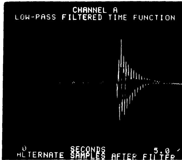
FIG. 6.8 SEÑAL EN EL TIEMPO DE LA ACCELERACIÓN DEL MODELO
