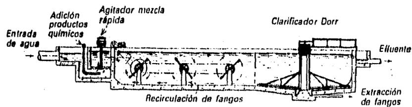
**Fig. 5.8 Mezcla rápida floculación y sedimentación**
