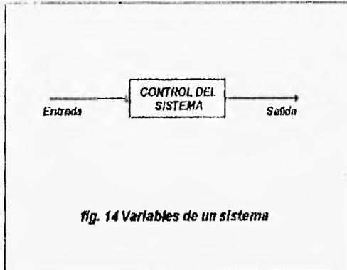
**Servosistema** .- Sistema de tipo automático escalable, capaz de regular, controlar y fijar a un valor determinado la variable en cuestión .
