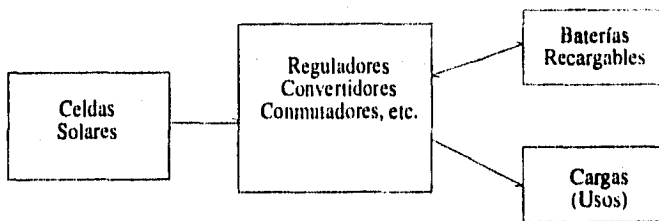
Figura 5.4. Configuración Básica del Subsistema de Energía Eléctrica
