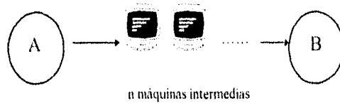
figura 1-4 Esquema que muestra una red del tipo almacenaje y re-envío (store and forward en inglés).
