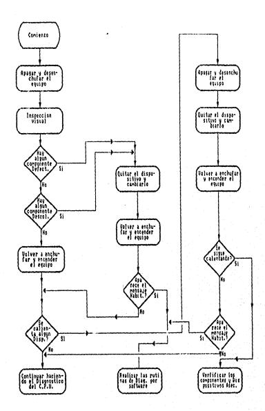
Figura IV. Deteccion de failas mediante la inspeccion visual
