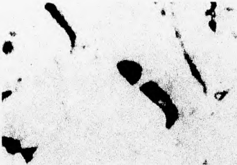
FIGURA 11. COMPOSITO DE Al(A356)/ SiC(P) MALLA 500 CON 3% DE Mg A 600x.
