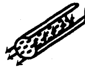
Diseño del recipiente cilíndrico mostrando las líneas de esfuerzo originadas por la presión interna.
