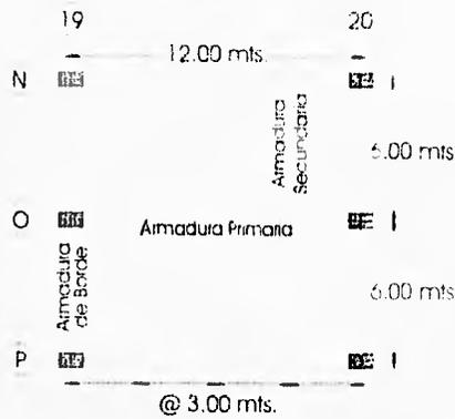
Analisis de carga por M<sup>2</sup> en losa entrepiso de losacero, apoyado en armaduras de acero en tableros de 3.00 x 6.00 mts. a ejes.
