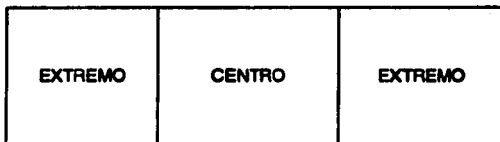
Fig. 25. Zonas de las probetas en donde se realizaron los ensayos de dureza Brinell.
