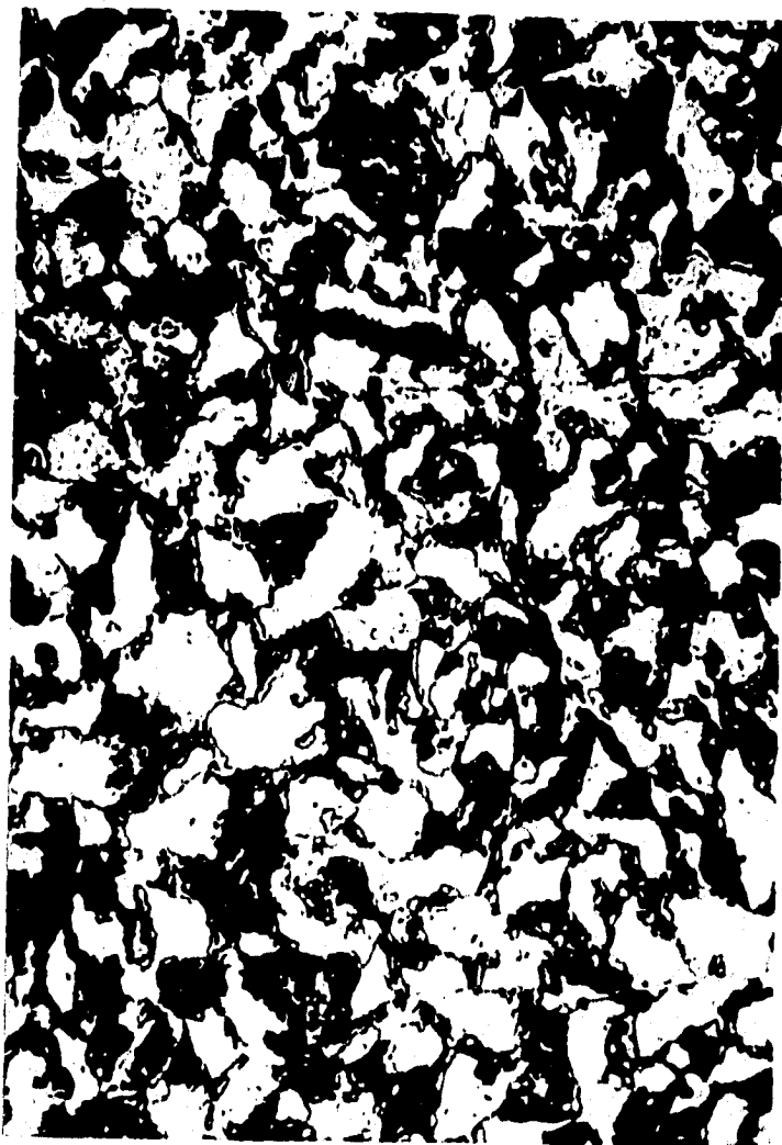
fig N° 27 Micrografía obtenida con microscopio óptico de un acero AISI - 1025 soldado mediante el proceso de arco sumergido, la imagen observada presenta granos equiaxiales de ferrita y probablemente de impurezas. Las (zonas oscuras) pueden contener perlita y bainita en su composición. Esta región corresponde a la zona de fusión de la soldadura. Se uso nital al 3% como atacante químico para la revelación de las microestructuras
