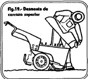
**Fig. 19.- Desmote de carcasa superior**
