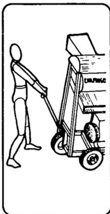
Por otra parte representa un problema para transportarla esto debido a su excesivo peso, o la inestabilidad misma de la máquina y al tipo de llantas que tiene.
