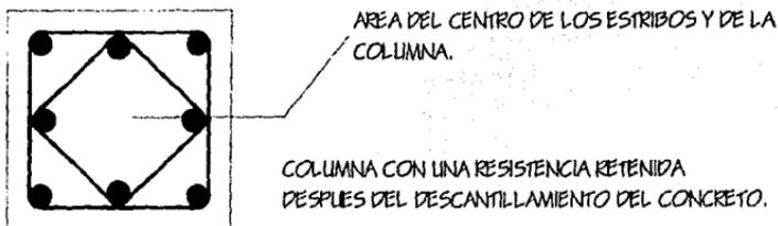
FIG.1 MUESTRA DE LA SECCION DEL CENTRO DE UNA COLUMNA.
