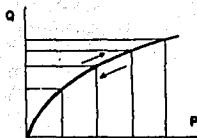
Escurrimiento turbulento (fisura grande, o falla del sello del obturador.)
