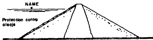
PRESA DE RELLENO HIDRAULICO
