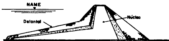
PRESA CON DELANTAL IMPERMEABLE
