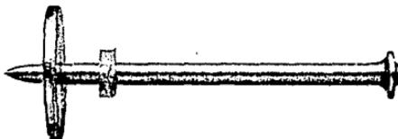
**Figura 7.4 Detalle de Clavo y Arandela a Manera de Anclaje (Pineda, 1995)**
