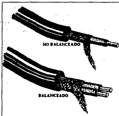
Fig.2.42. Cable apantallado o blindado
