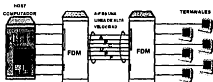
FIG 8 MULTIPLEXAJE POR DIVISION DE FRECUENCIA
