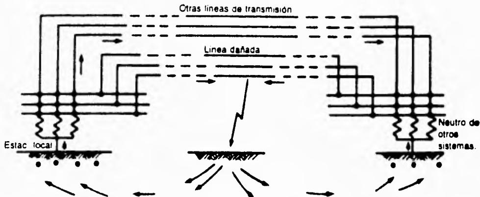
**Caso 4.** Falla en la línea fuera de la estación. Sistema a tierra localmente y en otros puntos. Parte de la corriente regresa de la tierra al sistema local de tierras y determina el aumento de potencial y gradientes allí. Casos 1, 2 y 3 muestran fallas dentro del local de la estación. El caso 4 muestra una falla externa en la línea.
