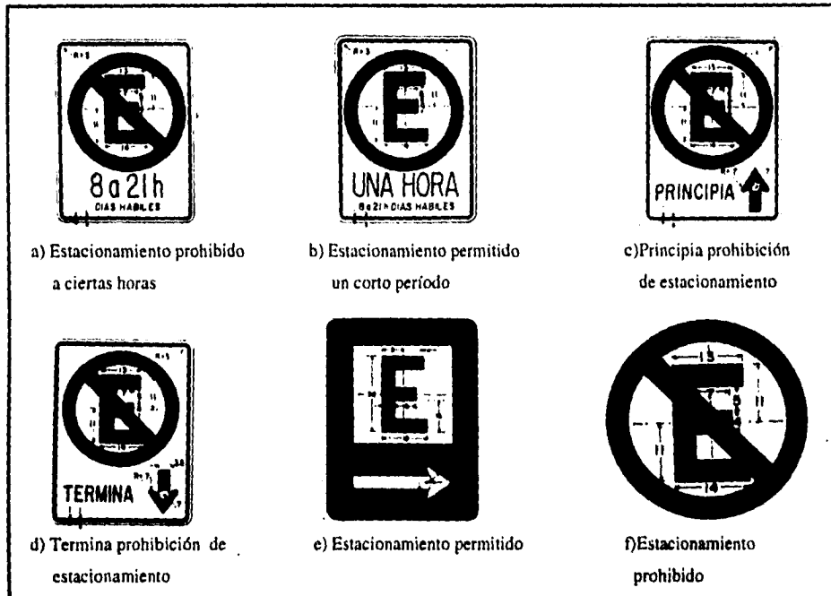
Figura 1.1.3 Señales de control de estacionamiento para las calles.
