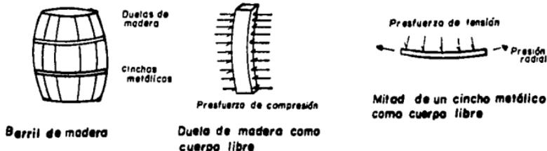
Los aros ó cinchos se apretaban con un esfuerzo de tensión creando un presfuerzo de compresión en las duelas habilitándolas para resistir la presión interna de un líquido. Con esto se comprende que el presfuerzo no es nada más que la introducción de esfuerzos a una estructura, armadura ó elemento, previos a la carga de servicio.
