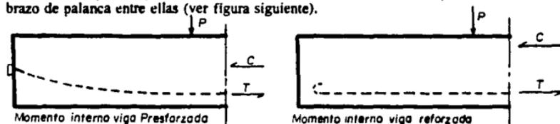
En el concreto presfuerzoado se utiliza el acero de alta resistencia, teniendo que alargar mucho antes de llegar a su resistencia total; así si este acero se ahoga solamente, el concreto se agrietará antes de que el acero desarrolle toda su resistencia.
