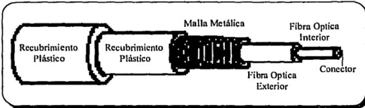
Figura 2.3 Cable de Fibra Óptica
