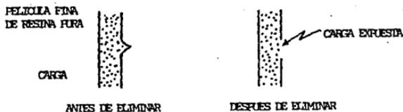
FIGURA 4.1 EFECTO DE ELIMINAR LA REBAPA DE UNA PIEZA DE PLASTICO QUE CONTIENE CARGA.
