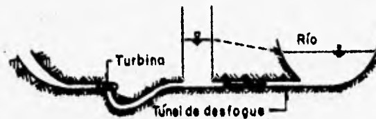
Fig. 6.11.- Cámara aguas abajo de la casa de máquinas
