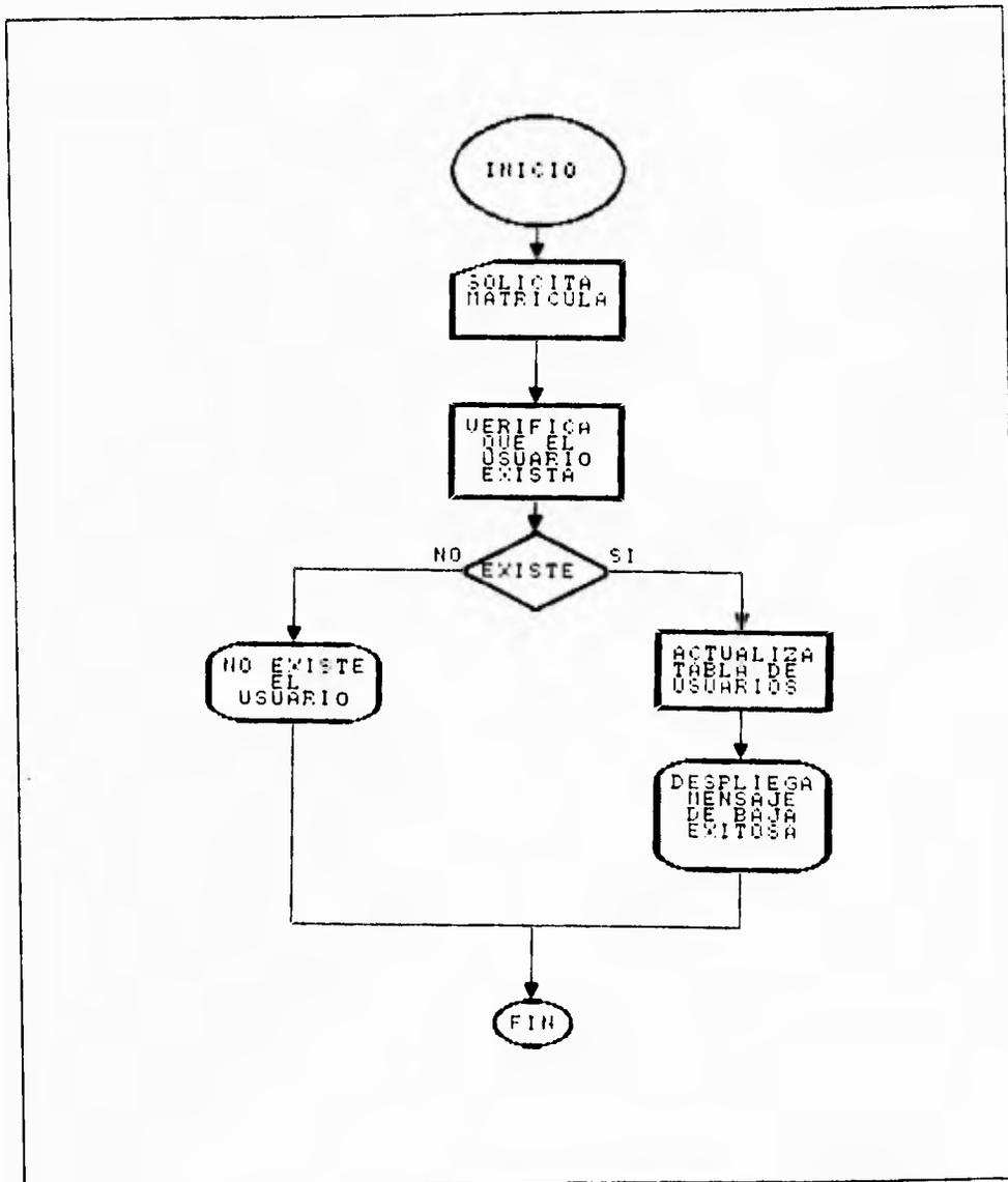
Figura IV.1.5.6 Mantenimiento de Usuarios Bajas
