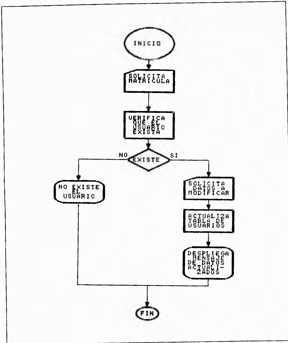
Figura IV.1.5.18 Mantenimiento de Tipos de usuarios Cambios
