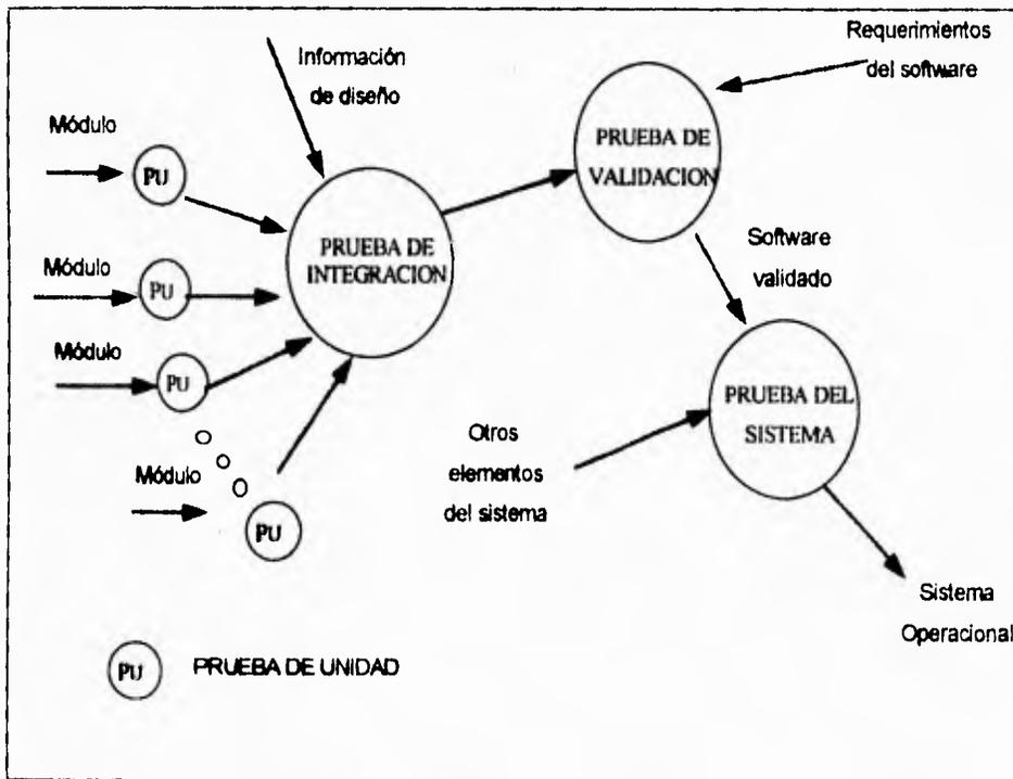
Figura IV.2.1 Pasos de prueba de software
