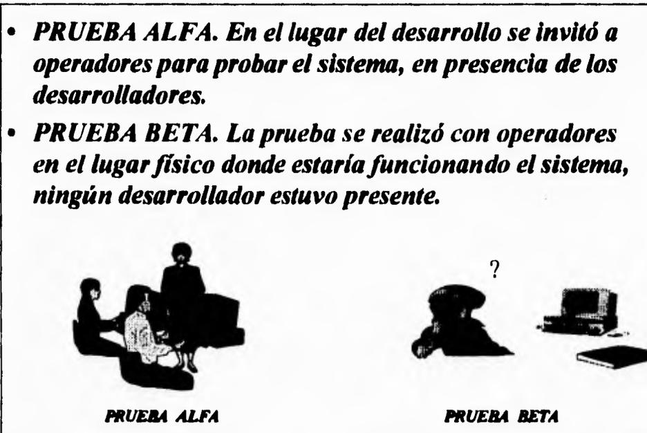
Figura IV.2.12. Pruebas alfa y beta como pruebas de validación.
