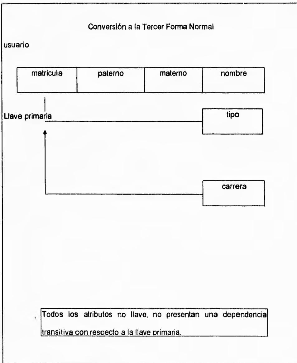
Figura IV.1.4.19 Aplicación de la tercer forma normal a las tablas del sistema de apartado, en específico a la tabla de usuario.
