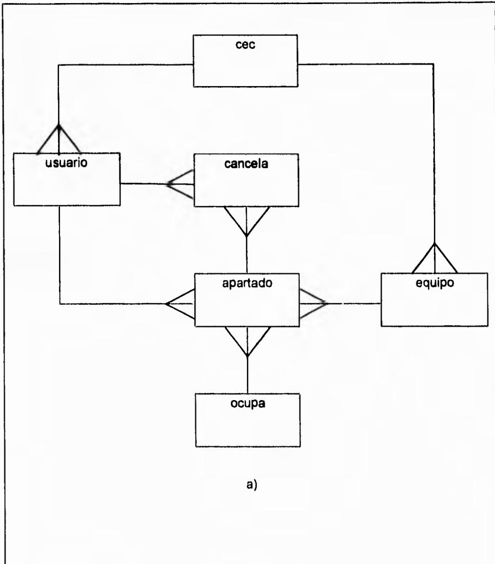
Figura IV.1.4.10 a) Diagrama entidad relación del sistema de apartado del C.E.C.
