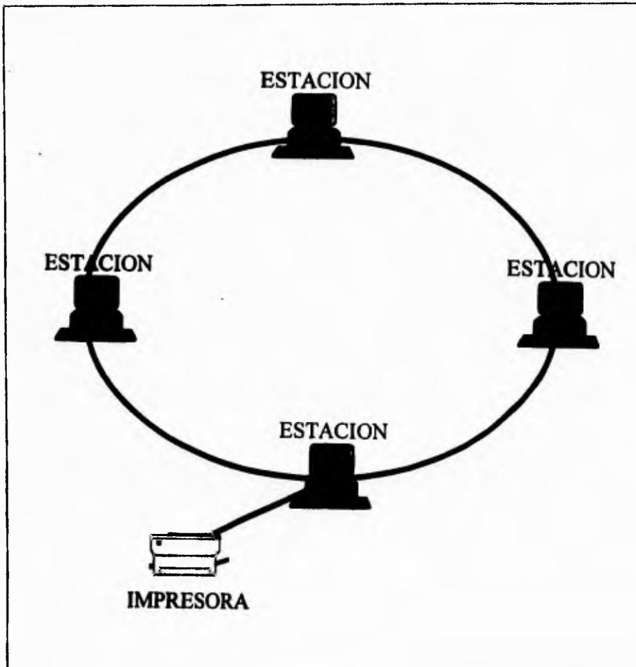
Figura II.6.3 Topología en anillo. Cada una de las estaciones se conecta con la siguiente, resultando la forma geométrica de un anillo.
