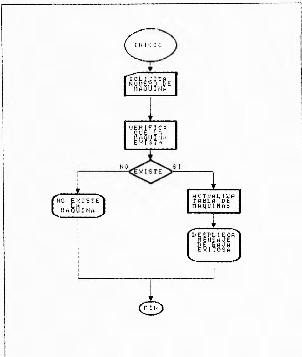
Figura IV.1.5.10 Mantenimiento de Máquinas Bajas
