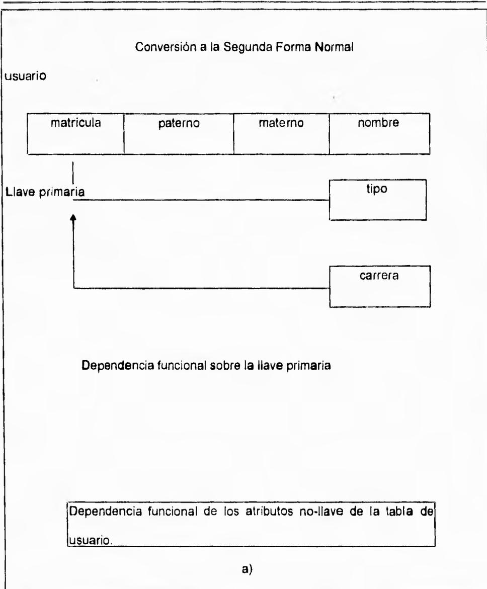
Figura IV.1.4.18 a) Revisión de las tablas del sistema de apartado para su conversión a la segunda forma normal.
