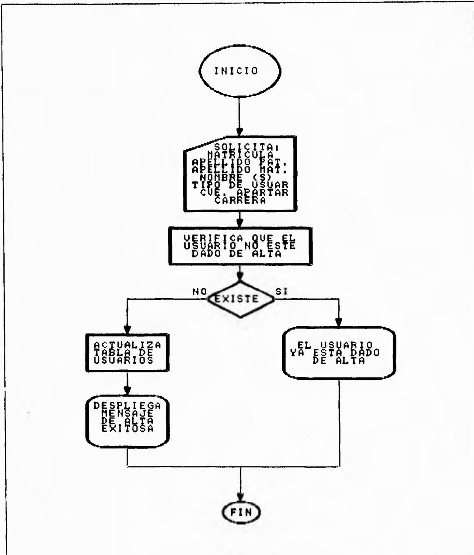
Figura IV.1.5.17 Mantenimiento de Tipos de usuarios Altas
