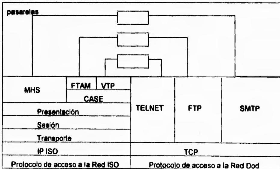
Figura II.6.10 Funcionamiento de una Pasarela
