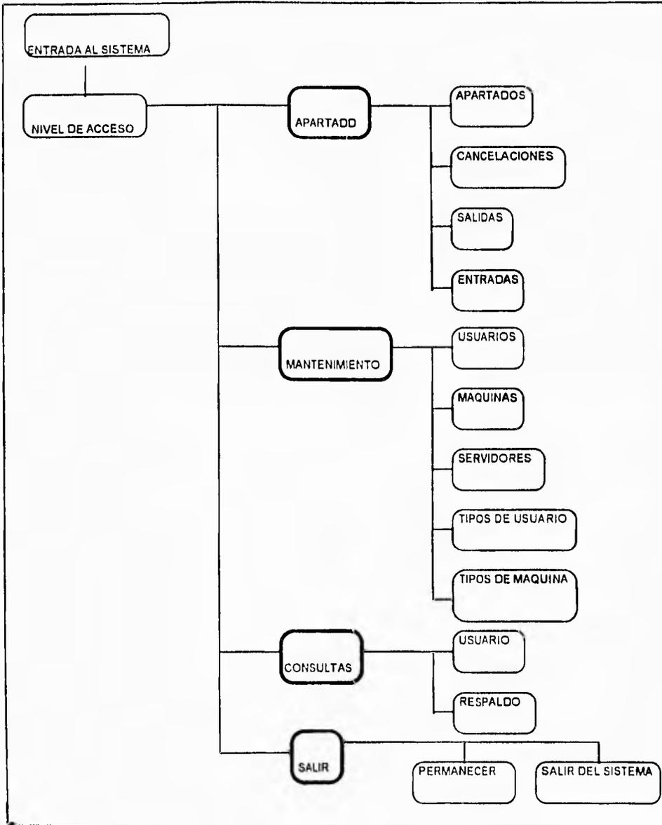
Figura III.4.2.1 Diagrama de Descomposición Funcional.
