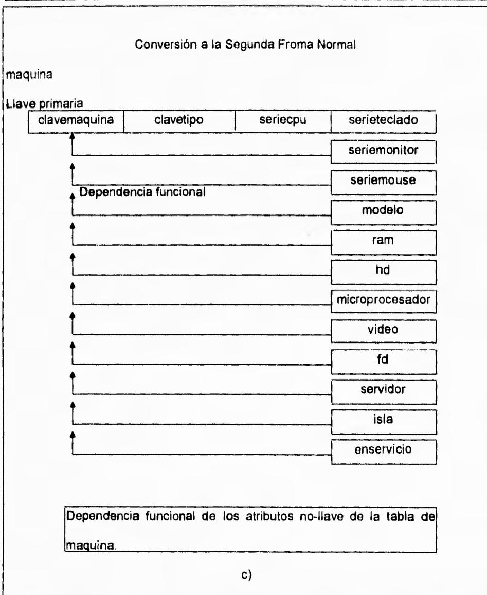
Figura IV.1.4.18 c) Revisión de las tablas del sistema de apartado para su conversión a la segunda forma normal.
