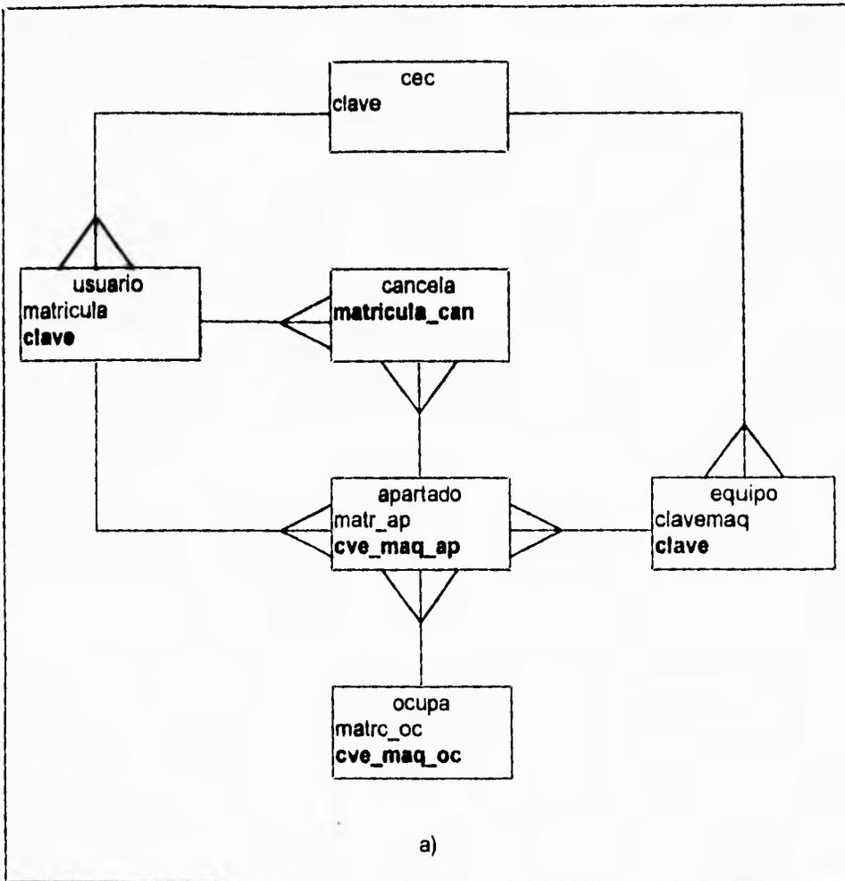
Figura IV.1.4.12 a) Diagrama entidad relación del sistema de apartado del C.E.C. mostrando las llaves secundarias.
