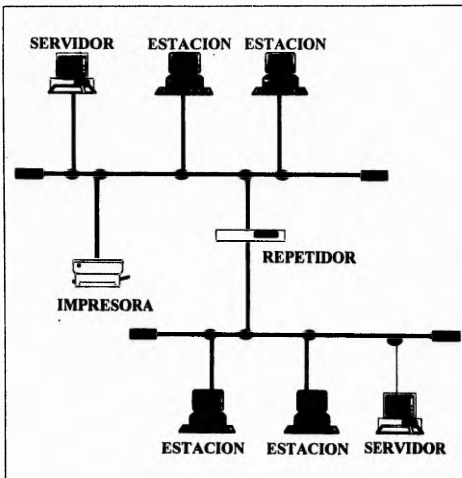
Figura II.6.2 Red de grandes dimensiones con estructura de múltiples buses.
