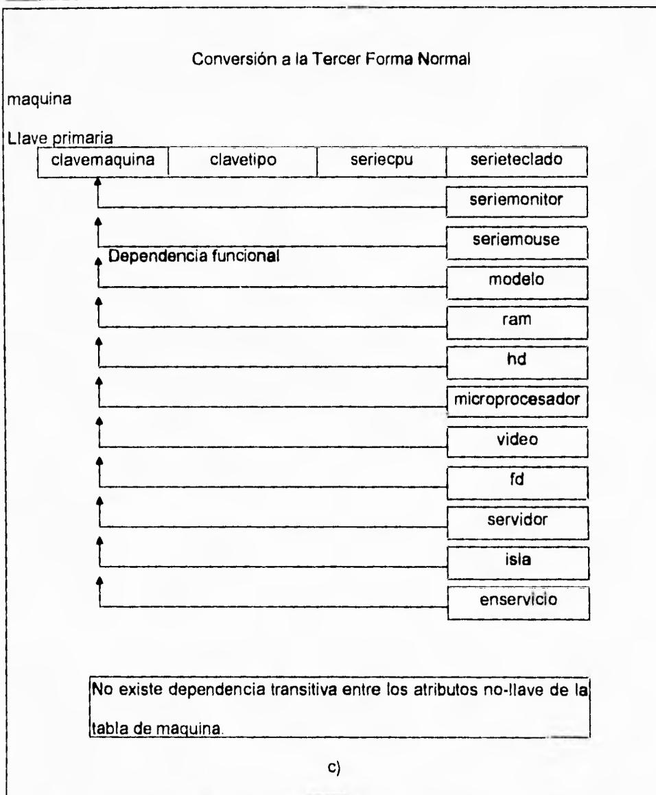
Figura IV.1.4.20 c) Revisión de las tablas del sistema de apartado para su conversión a la tercer forma normal.
