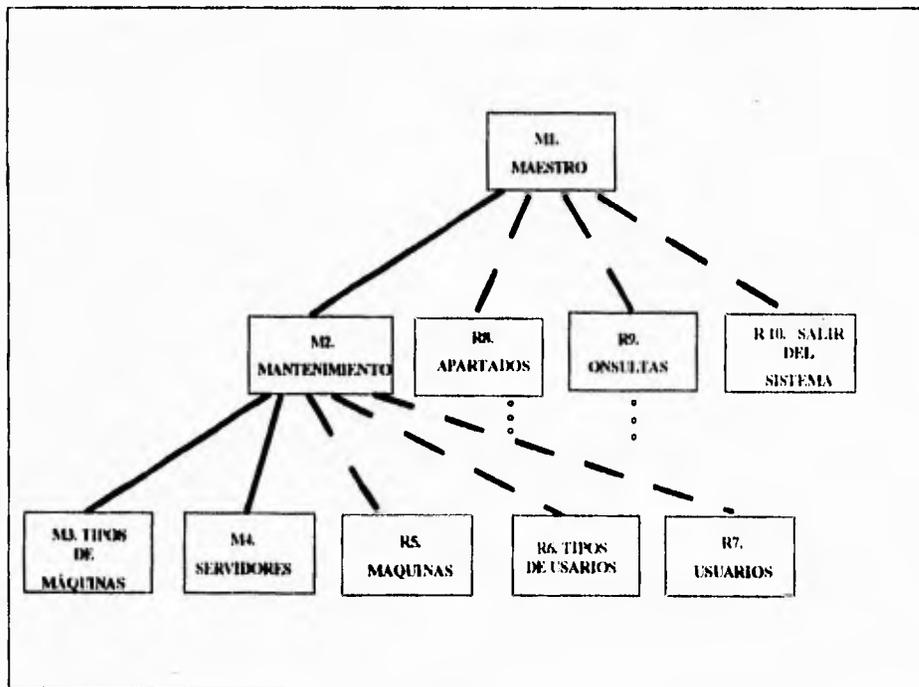
Figura IV.2.11. Integración descendente de forma primero en profundidad.
