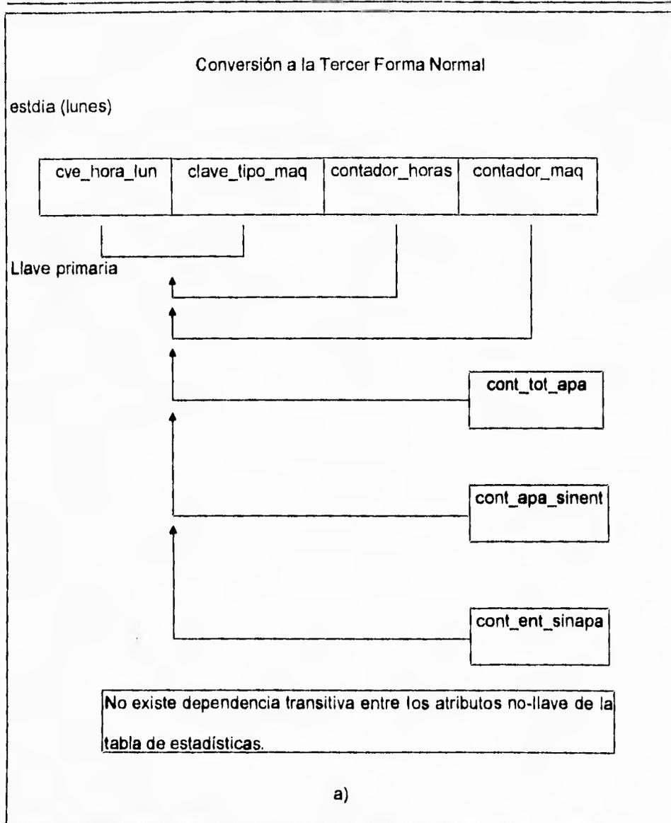
Figura IV.1.4.20 a) Revisión de las tablas del sistema de apartado para su conversión a la tercer forma normal.
