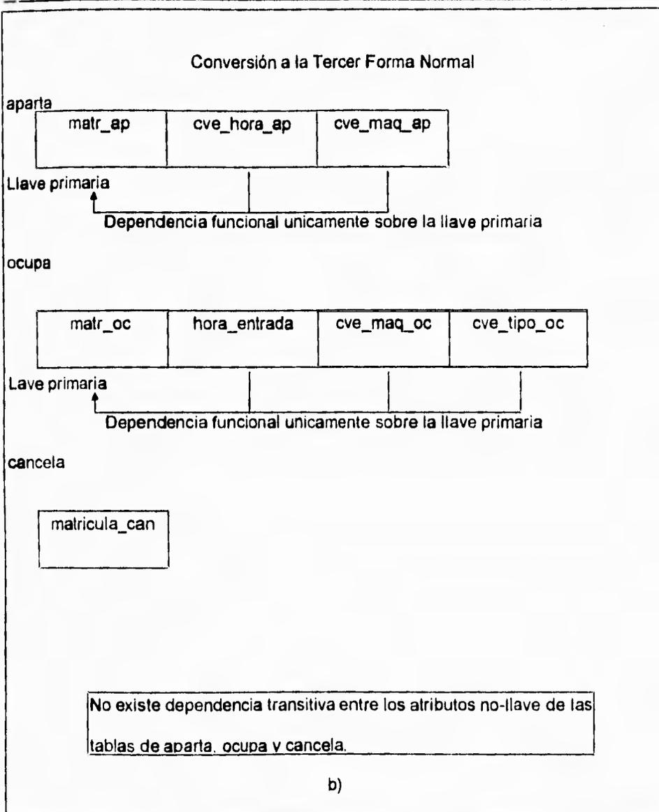
Figura IV.1.4.20 b) Revisión de las tablas del sistema de apartado para su conversión a la tercer forma normal.
