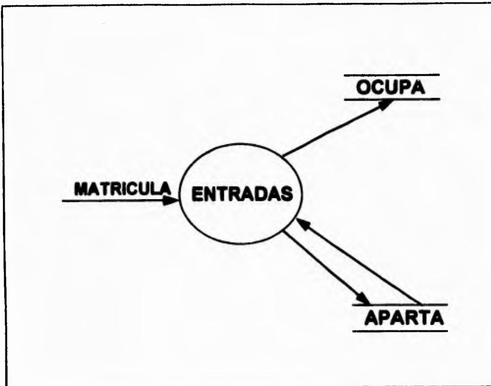
Figura IV.1.2.2 Diagrama de flujo de datos Entradas
