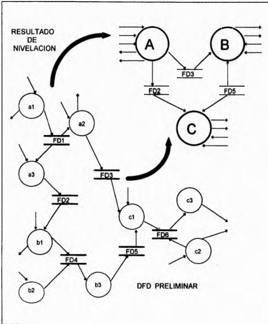
Figura II.2.3.10 Nivelación ascendente del DFD.
