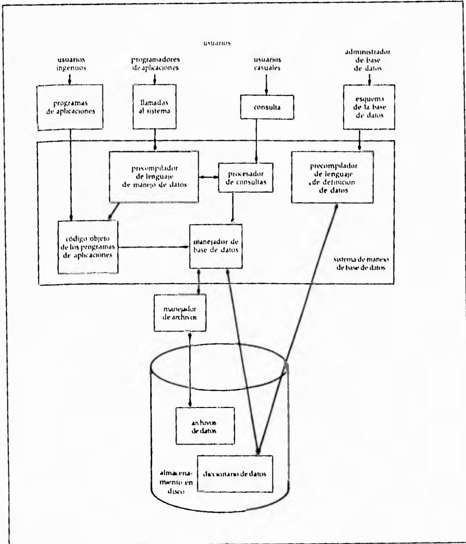
Figura II.1 1.5 Estructura general de un Sistema de Bases de Datos
