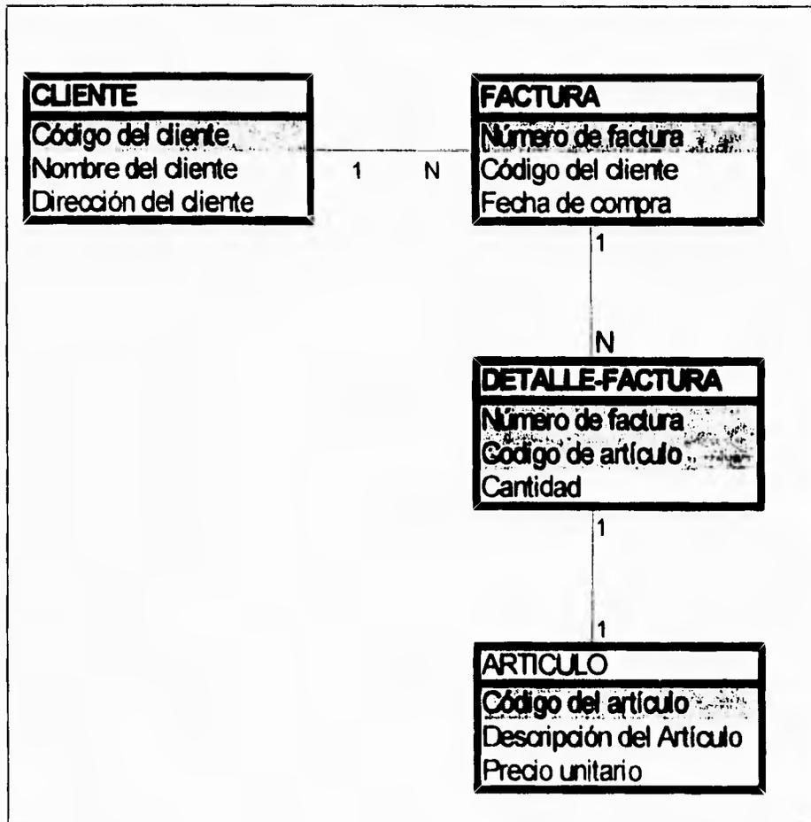
Figura II.1.3.8. Relación entre tablas de ventas después de la normalización
