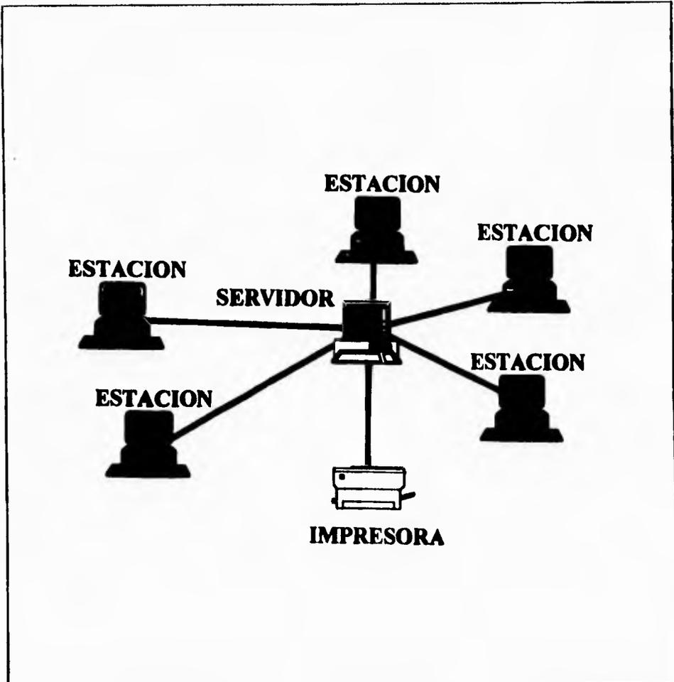
Figura II.6.4 Topología en estrella. Todas las estaciones de la red se conectan a una unidad de control central.
