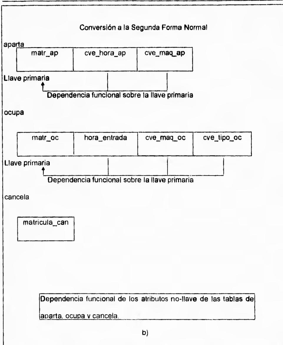
Figura IV.1.4.18 b) Revisión de las tablas del sistema de apartado para su conversión a la segunda forma normal.
