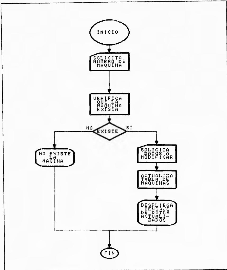
Figura IV.1.5.11 Mantenimiento de Máquinas Cambios
