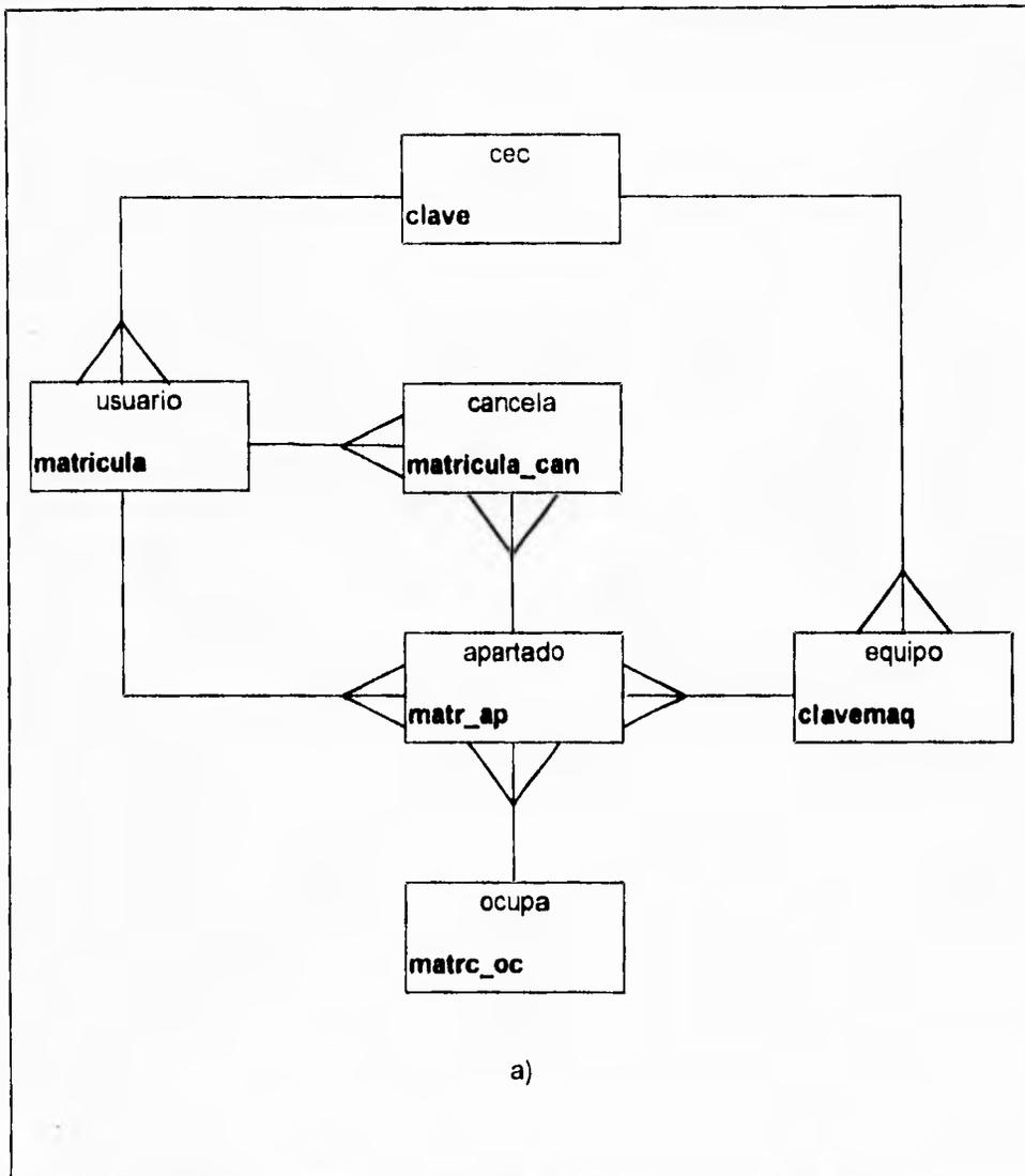
Figura IV.1.4.11 a) Diagrama entidad relación del sistema de apartado del C.E.C. mostrando las llaves primarias.
